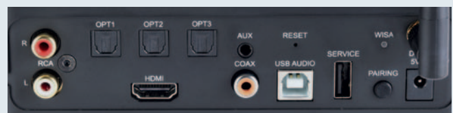
Unter den sechs Digital-Eingängen des WISA-Hubs findet sich sogar ein HDMI-Anschluss mit ARC, dem Audio-Rückkanal.
